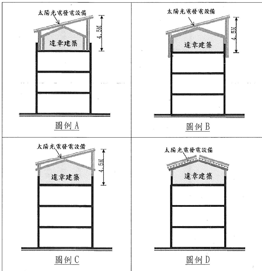
**附件 2：合法建築物屋頂存有違章建築設置太陽光電設備申請程序說明**
